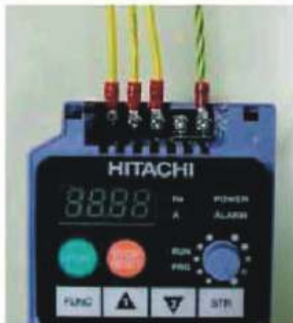
Rys. 3. Sposób podłączenia zasilania. Po lewej: jednofazowego, dla modeli oznaczonych -SFEF i -NFU, po prawej: trzyfazowego, dla modeli oznaczonych -NFU i -HFEF
