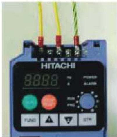
Rys. 3. Sposób podłączenia zasilania. Po lewej: jednofazowego, dla modeli oznaczonych -SFEF i -NFU, po prawej: trzyfazowego, dla modeli oznaczonych -NFU i -HFEF
